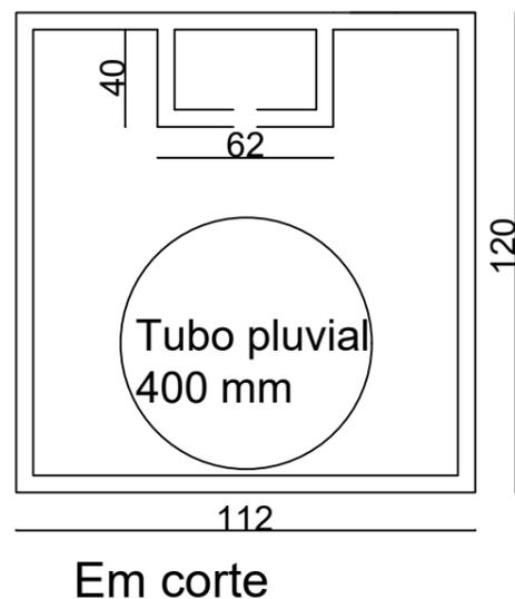
Paredes em tijolo ou pedra grês com emboço e reboco interno (e $\geq$ 16 cm).
