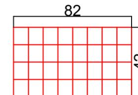
Grelha metálica com aço CA 50 16mm.
